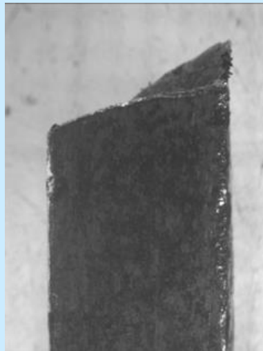
Lama di sciabola con rottura anomala
